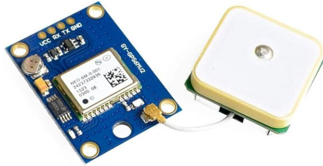
Şekil 3.10 Otonom araç kontrolünde konum belirleme için kullanılan GPS modülü
